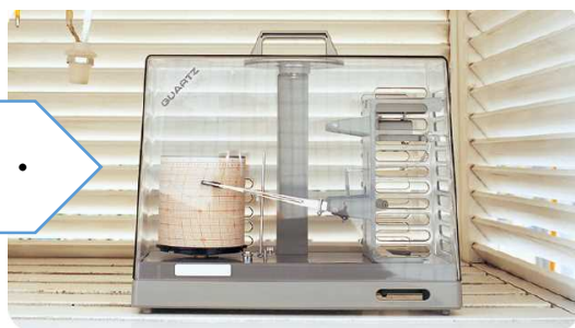
きろくおんどけい 記録温度計 気温の変化を連続して自動で記録することができるよ！
