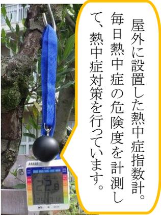
屋外に設置した熱中症指数計。毎日熱中症の危険度を計測して、熱中症対策を行っています。
